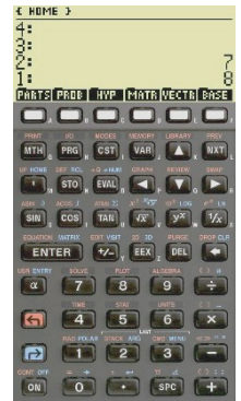
Calculatrice HP48SX On note la présence d'une pile dont les 4 derniers niveaux sont visibles ici
